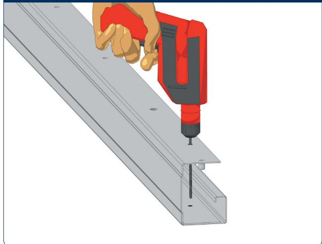
Просверлите сквозные отверстия в направляющих при помощи сверла под саморезы или анкерные болты.
