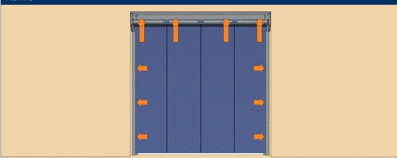
Установите и закрепите противоположную направляющую в проеме.
