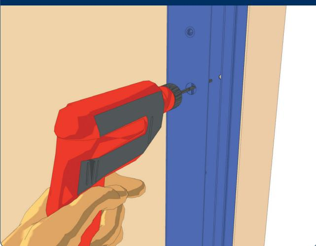
Просверлите отверстия в стене для саморезов или анкерных болтов.
