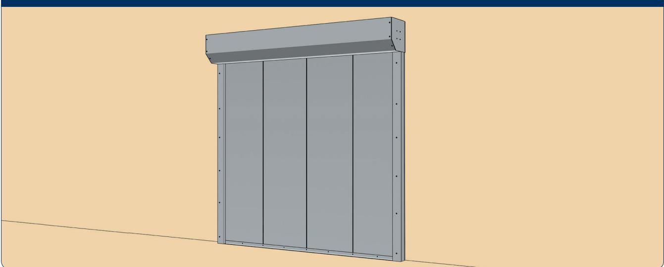
Проверьте правильность и надежность установки конструкции. Поднимите и опустите насколько раз полотно противодымной шторы. Убедитесь в отсутствии посторонних звуков и в надежности крепления всех элементов.
