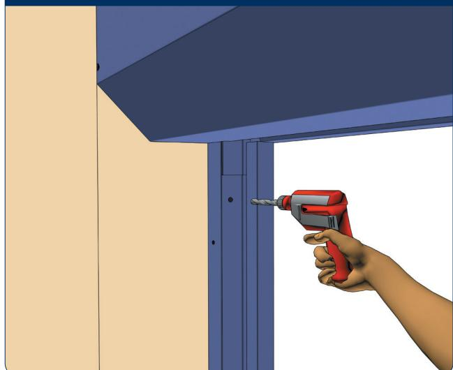
Просверлите отверстия для крепления каркаса противодымной шторы к стене.
